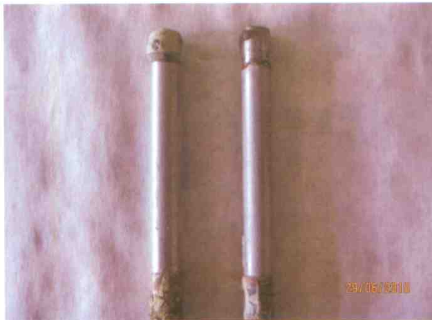
Rys. 12. Elektrody zabezpieczone w całości materiałem Hydrostop-Mieszanka, prod. nr 203. Zdjęcie wyglądu po badaniu.
