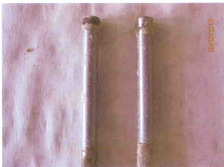
Rys. 15. Elektrody zabezpieczone w 50% materiałem Hydrostop-Mieszanka Profesjonalna, prod. nr 209. Zdjęcie wyglądu po badaniu.
