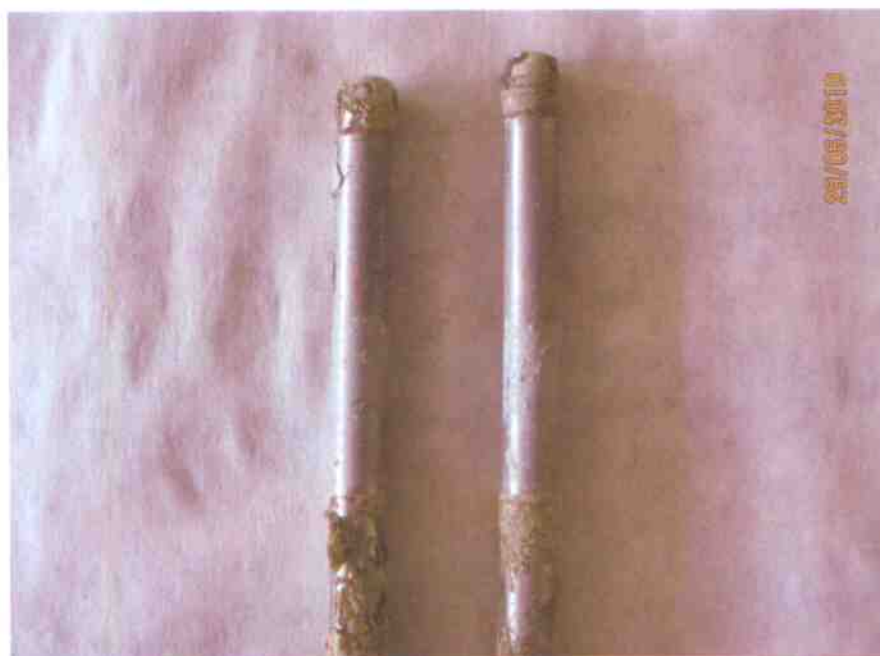
Rys. 13. Elektrody zabezpieczone w 50% materiałem Hydrostop-Mieszanka, prod. nr 203. Zdjęcie wyglądu po badaniu.
