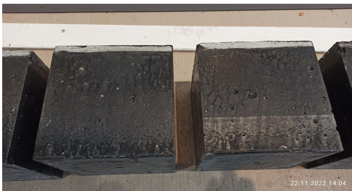
Fot. 2.b. Próbkki z zaprawą z dodatkiem Hydrostop-Plastu po badaniu na wodoszczelność, a przed rozłupywaniem. Brak oznak przecieku (zawilgocień, solaryzacji) zarówno na części betonowej jak i na ściankach warstwy zaprawy (w górnej części próbek).
