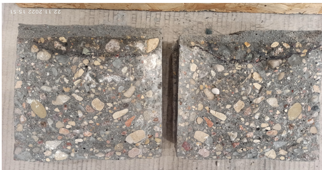
Fot.3 Penetracja wody przez warstwę zaprawy do betonu w próbce kontrolnej K1.
