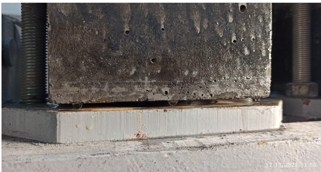
Fot. 1. a. Próbka kontrolna K1 przy ciśnieniu wody 0,2 MPa. Widoczne krople wody na dolnej krawędzi będącej jednocześnie krawędzią warstwy zaprawy.
